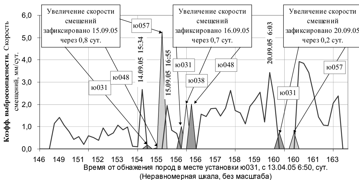
Рис. 6 – Сопоставление моментов активизации сеймики и возрастания скорости сдвижений кровли
